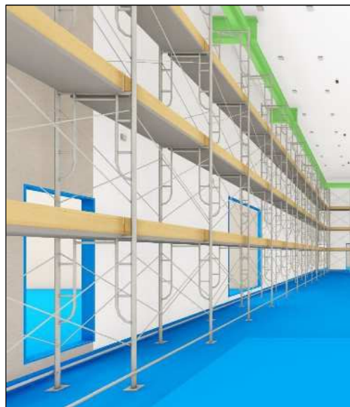
天井および壁面石膏ボードの撤去（内部足場もしくは高所作業車使用）
