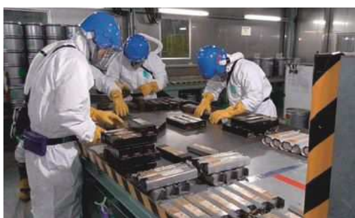
処理促進策(安定器の仕分け作業の様子)
