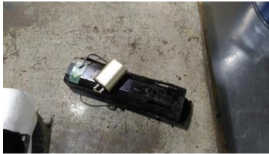
外付け型安定器のコンデンサー取り外し
