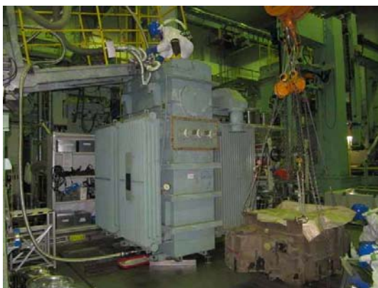
トランスの抜油・粗洗浄 (大型ステーション)
