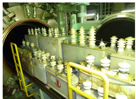
真空加熱分離炉に投入する コンデンサ
