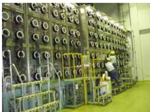
グローブボックスでのコンデンサ処理の状況
