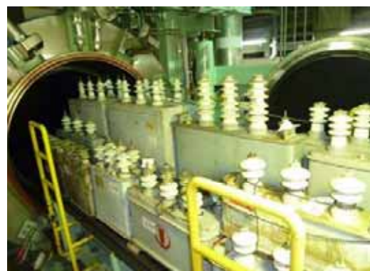
V T R加熱炉に投入するコンデンサ
