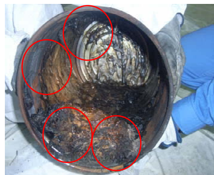
図 2-11 ペール缶の内容物とサンプリング箇所
