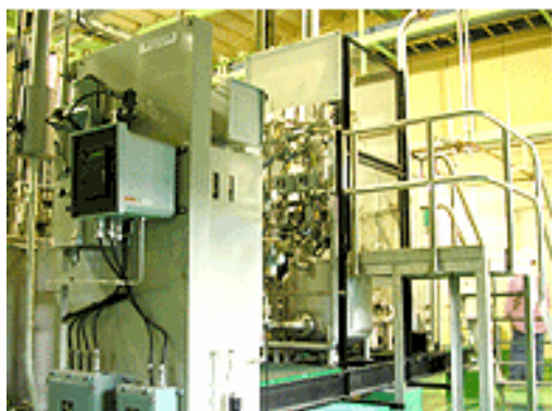
プラズマ分解処理装置(ホームページより) この装置の中で、アルゴンプラズマにより PCB を瞬時に分解する。
