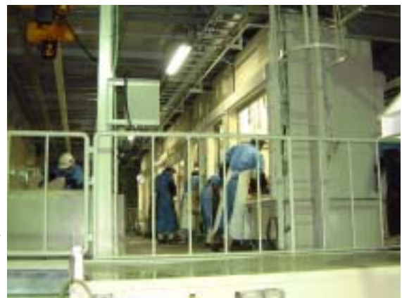
柱上トランス解体作業の様子 作業員は、防塵マスク(活性炭入り)、ゴム手袋、前掛けを着用し、フードの中(常時換気を行っている)で作業を行う。 (ここで解体された後はコンベアーで、自動的に洗浄工程へ移動)
