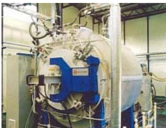
真空加熱分離装置（提供資料より） （手前の扉を開けて処理物を中に入れる）
