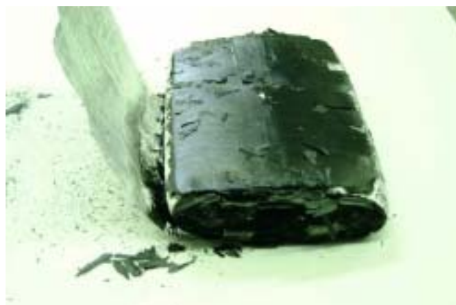
真空加熱分離後のコンデンサコア（提供資料より） （炭化した紙が、アルミ箔からはがれる）
