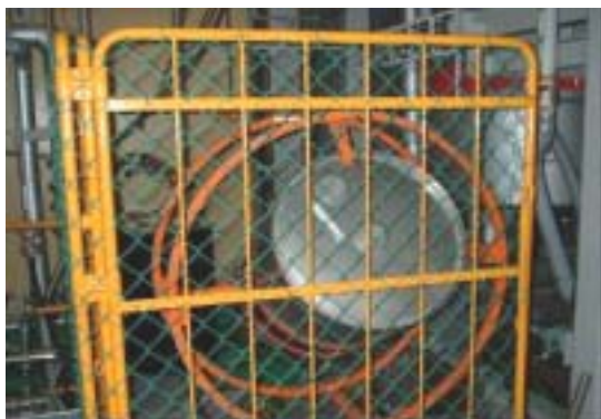
オレンジの円形枠を回転させ、S D の性状をドラム缶内で均一に保つ
